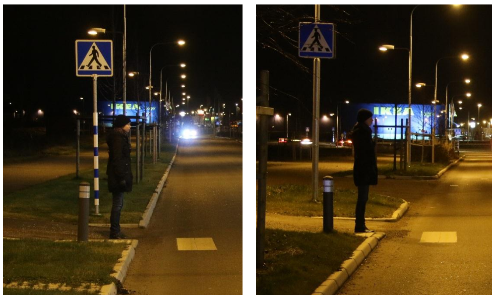
Figur 21: Fotgängaren framträder på olika sätt beroende på om belysningsstolpen står framför (vänstra bilden) eller bakom (högra bilden) övergångsstället. Bild: Joel Rosdahl.
