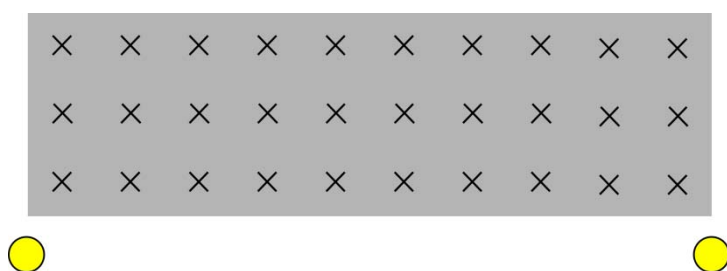
Figur 4: Belysningsstyrka och luminans beräknas i ett antal punkter i körfältet mellan två armaturer. Antalet punkter och dess placering beror på vägens bredd och avståndet mellan armaturerna.
